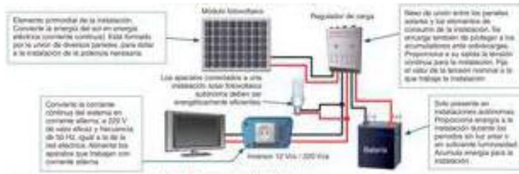
Figura 8: Componentes de una instalación solar fotovoltaica
