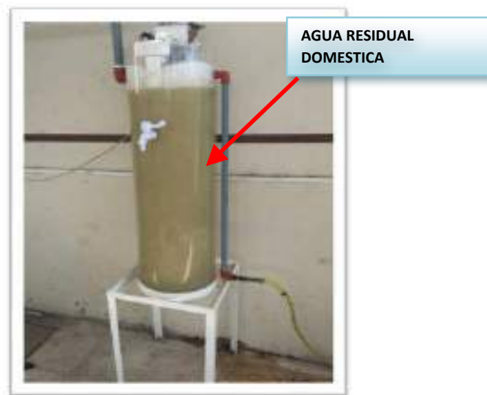
Figura 3. Vista del tiempo de reacción (aireación y agitación) en el interior del reactor aeróbico secuencial
