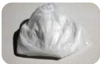
Ilustración 4. Mezcla de empaste con nuevo aglutinante
