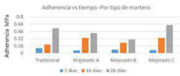
Figura 3. Resistencia por adherencia y por mortero. Edad de viga: 28 días
